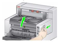
Desserrez les vis situées à chaque extrémité du guide de numérisation inférieur pour le démonter.
