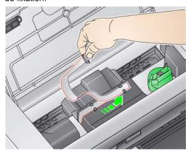
11. Insérez fermement le connecteur du câble de l'imprimante dans son support.
