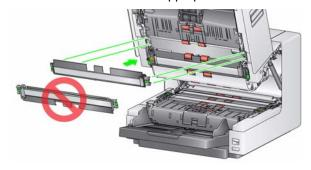
4. Desserrez le fond retournable supérieur. Desserrez les quatre vis à l'aide d'un tournevis.
